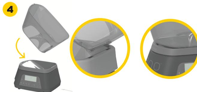
Coloque la TOLVA DE ALIMENTOS empezando por la parte trasera. Una vez enganchados los dos ganchos traseros, incline la TOLVA hacia adelante para bloquearla. Se enganchará con un chasquido. La conexión debe ser firme. Una vez instalada, NO la retire.
